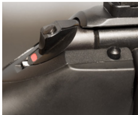
S101 säkras med en tangent i styrhysan. Slutstycket kan öppnas i säkrat läge när man trycker ner slutstycksspärrens knapp.
