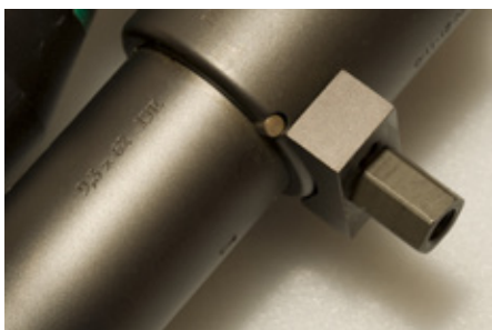
Rekyllacken hos Mauser M12. Bredvid syns stiften som indexerar den termisk infästa pipan i rätt läge.
