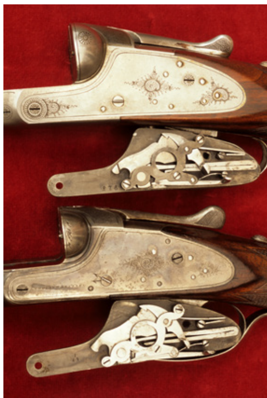
Överst en Husqvarna m/201 och under en Sauer från samma tidsperiod. Bössorna är identiska, det är ingen tvekan om att baskyl och låsar på Husqvarnabössan kommer från Sauer.
