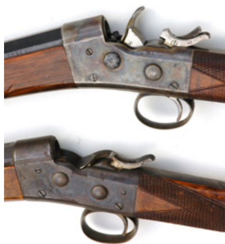
Den övre har stopphane samt är stämplad med N på slutstycket. Detta visar att delar av mekanismen är gjord i Nickelstål Detta infördes på 1930-talet, för att bättre klara det höga trycket från modern ammunition.
