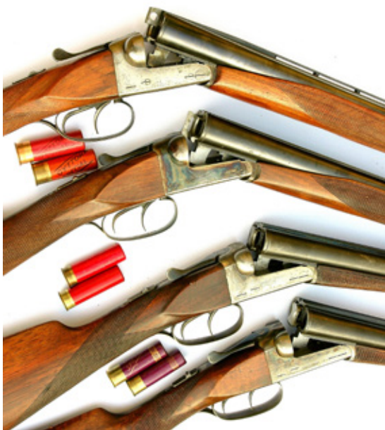
Fyra olika 350-bössor. Överst två skeetbössor, en med och en utan ventilerad spång. Under en 350 i kaliber 16 och underst en i kaliber 20. Det tillverkades endast ett fåtal 350-bössor i dessa klenare kalibrar.
