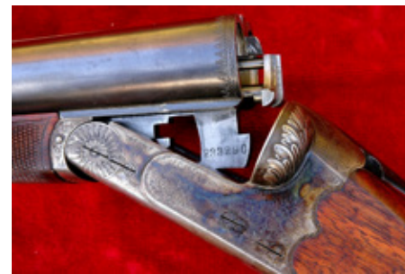
Modell 355 Extra Lyx som endast tillverkades i fem exemplar på 1950-talet. Den är byggd på 350 baskylen, men skulle mer efterlikna engelska bössor. Baskylen är slimmad, varbygeln är kort och har rundade kanter. De har 65 mm patronläge. Gravyren är mer ytlig än den normala Husqvarnagravyren, den är skuren med handstickel.
