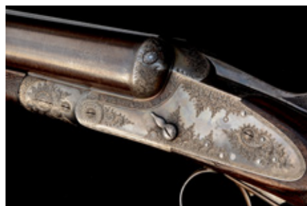
Sidolås m/60 med utsökt gravyr och fint damaskerade pipor. Jag tycker mycket om gravvren på denna bössa. Den är mycket välgjord och har en spännande, livfull utformning. Observera den stora visaren på sidan av låset. Den visar om låsarna är uppspända, den finns på alla Husqvarna m/60 bössor och även på Sauer sidolåsbössor från den tiden.
