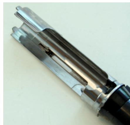
Ovanligt nog är utkastaren inbyggd i pipans förlängning i stället för i lådan.
