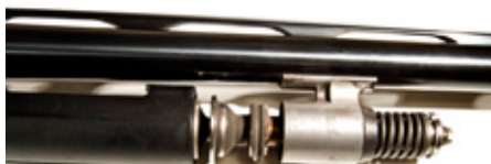
Bakre disken på pistongen rensar den invändiga ytan i cylindern.
