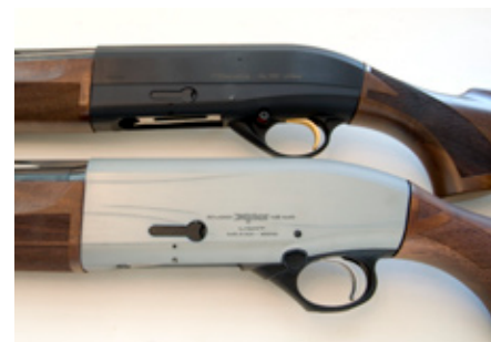
Den svarta hävvarmen på sidan om lådan blockerar matning från magasinet. Observera den ergonomiskt utformade och placerade säkringsknappen.
