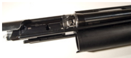
Slutstycket låser i pipan genom rotation medurs.
