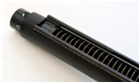
Returfjädersystemet är placerat framför lådan.
