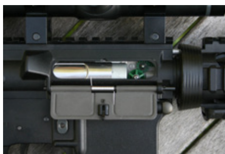
Denna modell saknar slutstycke, däremot finns ett gasrör och en fungerande deltagning till framstocken.
